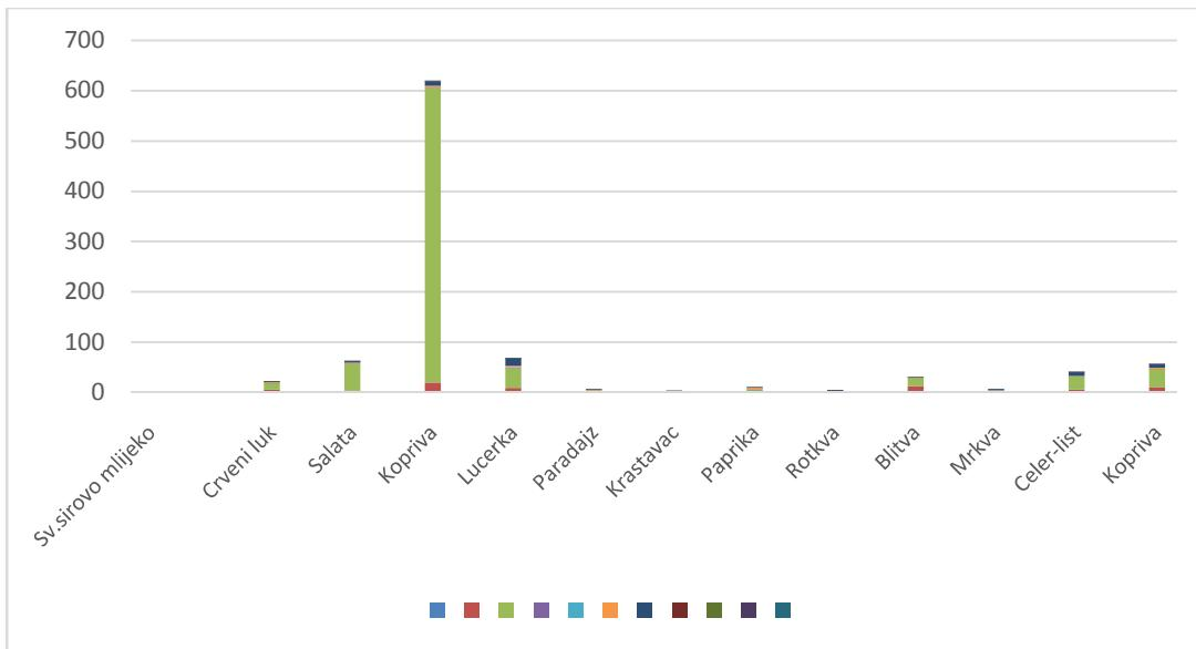
Na osnovu dobijenih rezultata može se reći da uzorak koprive sadrži veoma visoke količine željeza, te značajne količine mangana i cinka. U jednom uzorku koprive nađene su relativno visoke količine arsena i olova za koju nisu propisane MDK.
